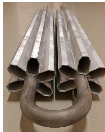
Fig. 4. Insertos para la mejora de transmisión de calor en el tanque de almacenamiento térmico.
